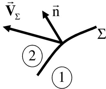
masse :  $\left\| \rho (\vec{V} - \vec{V}_\Sigma) \cdot \vec{n} \right\| = 0 \rightarrow \rho_2 (\vec{V}_2 - \vec{V}_\Sigma) \cdot \vec{n} - \rho_1 (\vec{V}_1 - \vec{V}_\Sigma) \cdot \vec{n} = 0$
