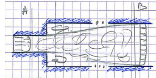
$$\frac{H_A - H_B}{\frac{1}{2} \rho V_d^2} = K (\text{Géométrie}, \text{Re}) \quad (*)$$
