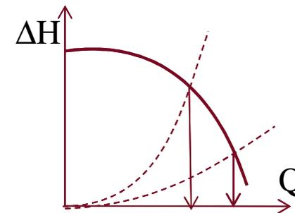
On augmente le diamètre de la conduite
